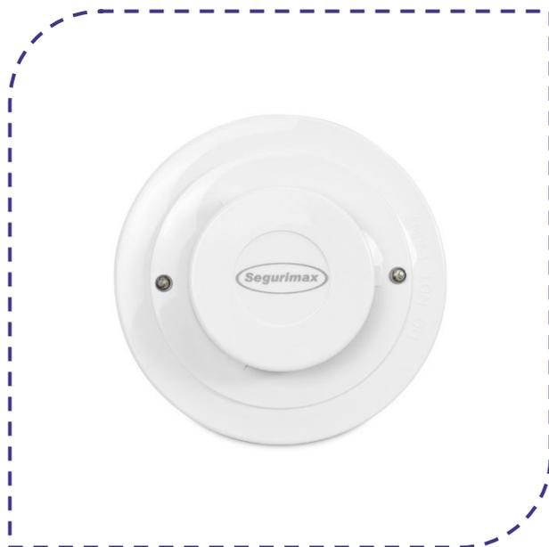
O Detector de Fumaça Endereçável Compact foi projetado para detectar a presença de fumaça no ambiente e enviar um sinal para a central endereçável Compact Segurimax. Seu componente sensor é uma câmara óptica que detecta partículas de fumaça produzidas por diversos tipos de materiais combustíveis.
